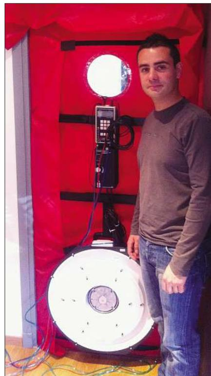
Grâce à un dispositif de « porte soufflante », Cédric Cuguru est en mesure de mettre en dépression l'atmosphère intérieure d'une maison pour vérifier son étanchéité à l'air. Et donc la bonne isolation de l'habitation. (Photo DR)
